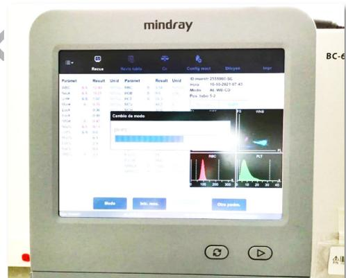
8. Una vez esté el indicador en verde, se puede cambiar el modo, para esto se presiona el botón de reversa (dos flechas cíclicas) y automáticamente el equipo cambia el modo.
