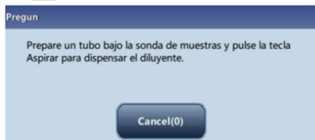
16. Presentar un tubo centrífugo limpio sin taponar sin anticoagulante a la sonda de muestra verticalmente asegúrese de que la sonda de muestra llegue al fondo del tubo.
