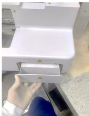
2. Desechar las cubetas usadas, ubicadas en un cajón al frente del equipo en la parte inferior.
