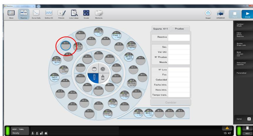
12. Dirijase al costado izquierdo y de clic en cambiar. El equipo posicionará la gradilla seleccionada en la compuerta de salida.
