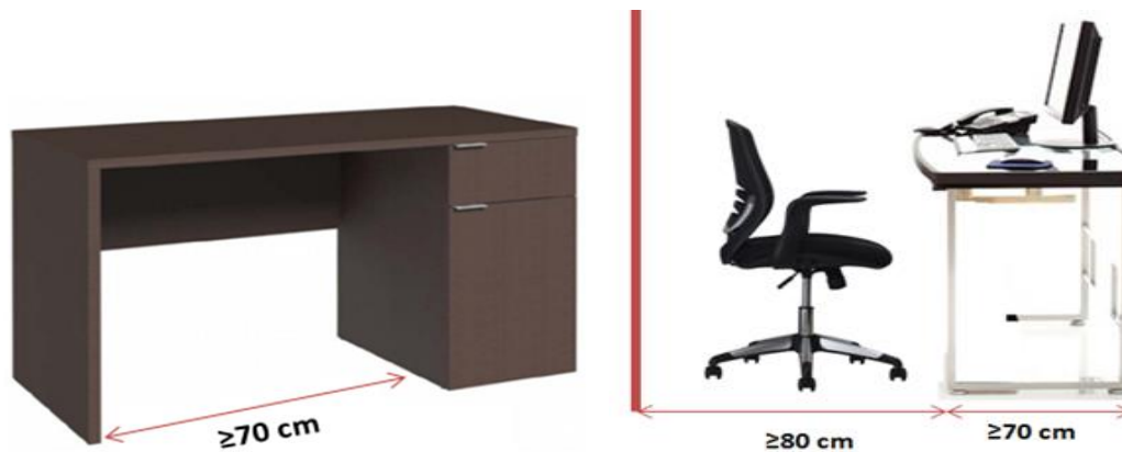
Figura 2. Espacio reservado para los miembros inferiores. (Estas dimensiones se encuentran en cm)
